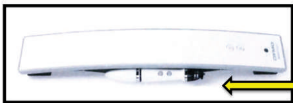
Figuur 6: Draagbare magneetarm waarin die stilus (elektroniese pen) en "hub" gestoor word
